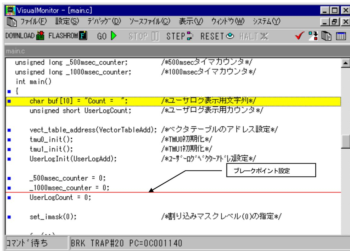
ブレーク設定の解除も、右クリックで行います。詳細は「リモートデバッグ編」を参照してください。
