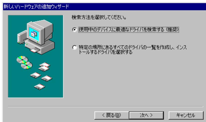
4) PCがドライバの検出先を要求してきた場合は、フロッピーディスク内の [Driver] ディレクトリを指定してください。
