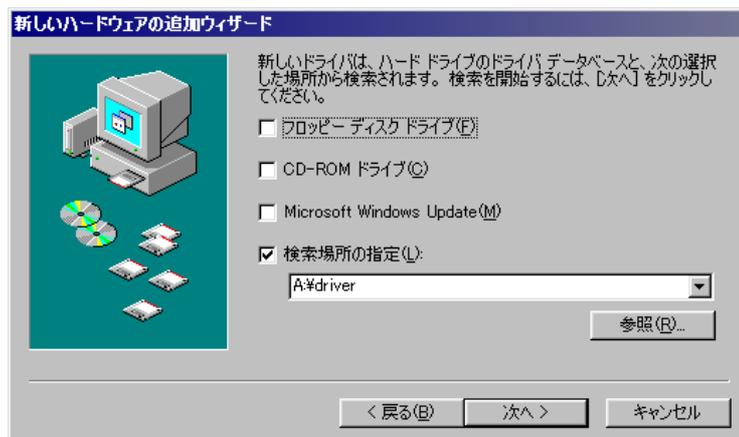
5) [次へ] を選択すると、USB High Speed Serial Converter デバイス・ドライバのインストールを開始します。
