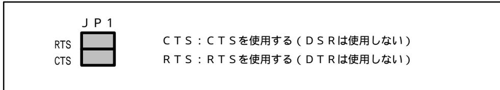
通常はC T SとR T Sの組み合わせ、もしくはD S RとD T Rの組み合わせで使用してください。
