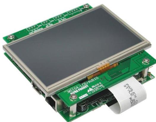
Fig 4.2-1 MS104-SH4AG との接続例
