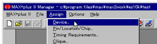
本ボードに搭載されているCPLDはFLEX10KA デバイスですので Device Family: 欄で「FLEX10KA」を選択します。
