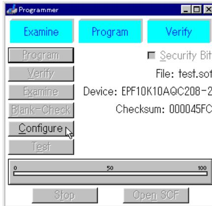
下のようなダイアログが表示されればコンフィギュレーションは完了です。失敗するようでしたら電源・ボードの設定・ダウンロードケーブルの接続が正しいか、再度確認して下さい。
