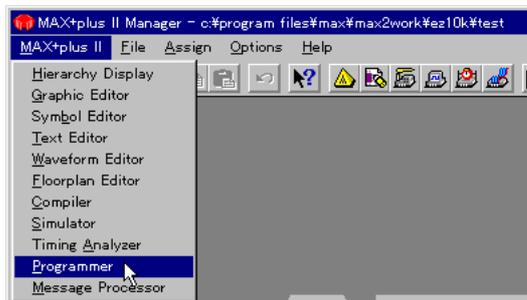
MAX+plusにてコンパイルを行った後やプロジェクト設定が正しく行われている場合にはProgrammerを開いた時点で自動的にプログラムが読み込まれますのでへ進んで下さい。
