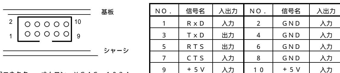
図2.3-4 TTL用コネクタ ピンアサイン
