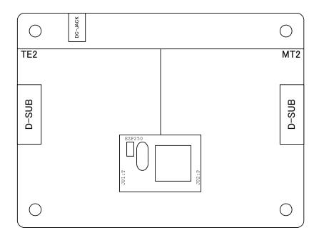
Fig 2.1 EZP-200 EVA への EZP-250 の搭載方向
