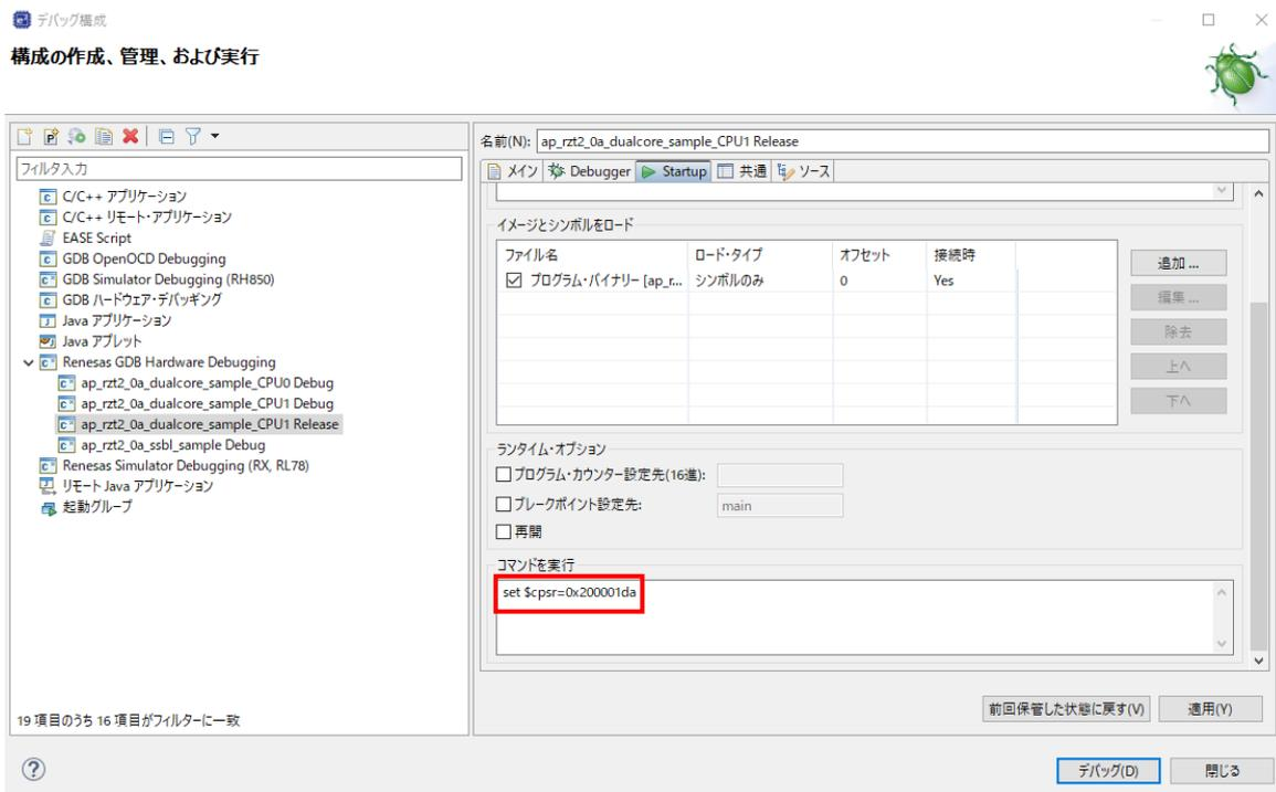
19. 「適用」ボタンを押して設定を保存し、続けて「デバッグ」ボタンを押します。
