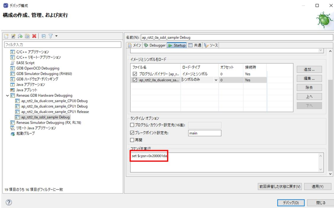
11. 「適用」ボタンを押して設定を保存し、続けて「デバッグ」ボタンを押します。
