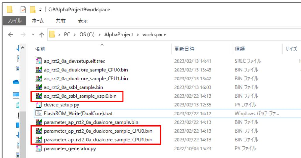
メッセージ「Send program data. (S3)」が表示されない場合、バッチファイル内のコマンド「python device\_setup.py start ~」が正常に動作していません。
