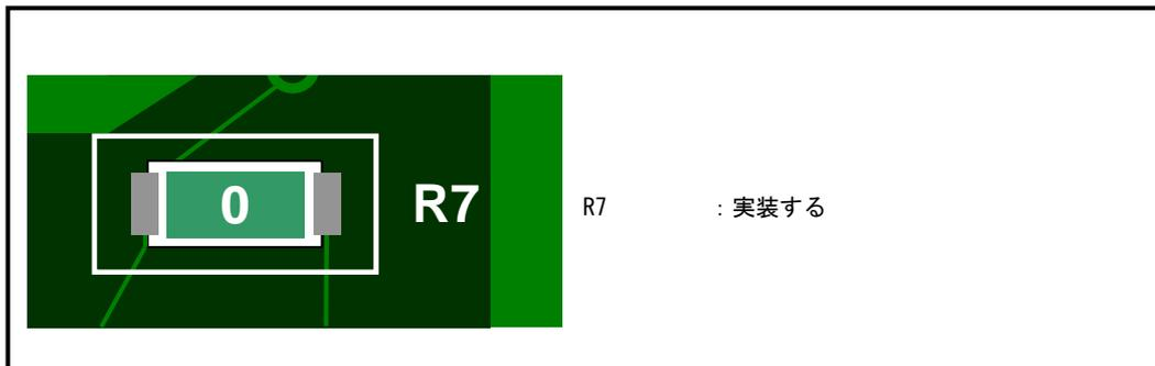
Fig 1.3-4 SDRAM 動作切り替え抵抗
