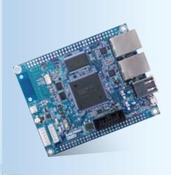
RX64M は、4MB の ROM、512KB の RAM の大容量メモリを搭載し、 周辺機能として、Ethernet 2ch、USB 2ch、CAN などの通信機能の他、 カメラ入力、SD カード、A/D 変換器、D/A 変換器等の豊富なインタフェ ースを備えています。
