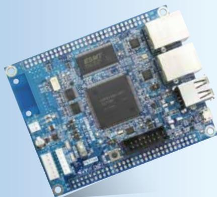
RX71M は、最大 240MHz で動作し、ノーウェイトアクセス 可能な 4MB の大容量フラッシュメモリを搭載しています。周辺機能として、Ethernet 2ch、USB 2ch、CAN などの 通信機能の他、カメラ入力、SD カード、A/D 変換器、D/A 変換器等の豊富なインタフェースを備えています。
