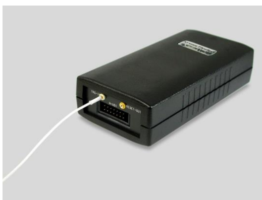
Fig 2.3-4 EXT-TRG ケーブルの接続
