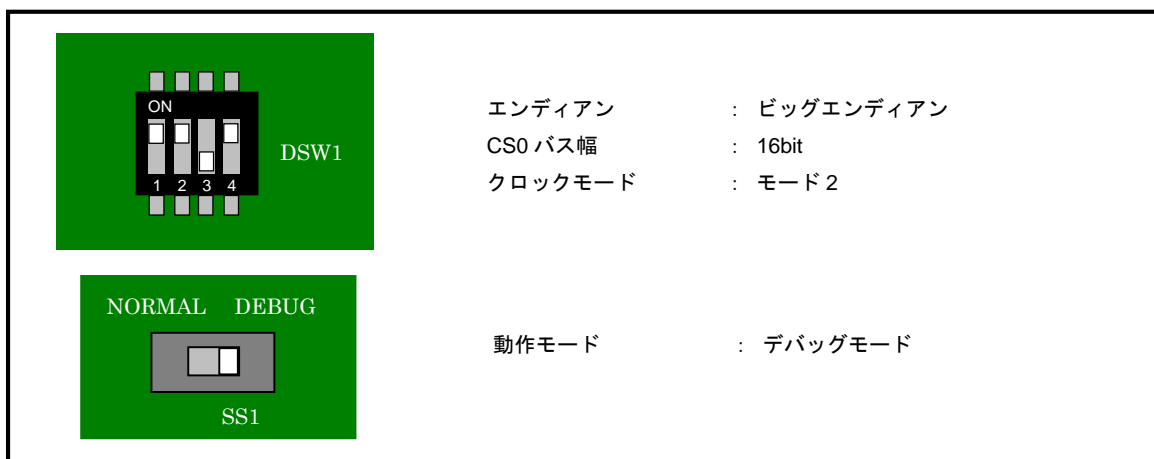
Fig4.1-1 デバッグ時の CPU 動作モード設定 (AP-SH4A-1A)
