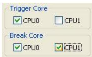
Setup Breakpoint ダイアログを開き、Break Core の CPU1 をオンにし、OK をクリックします。
