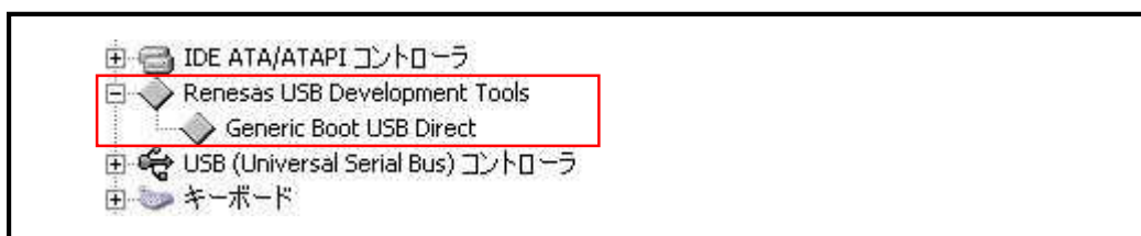
Fig 3-2 正しいUSBドライバの表示
